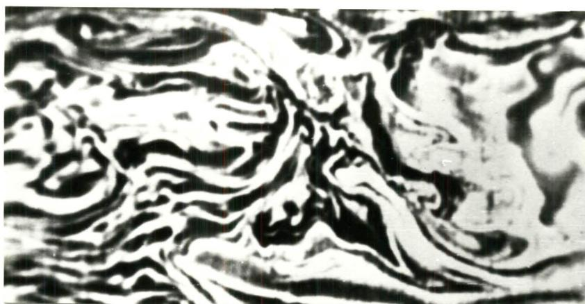
Рис.4.14. Макроструктура стали № 7  $\times 10$
