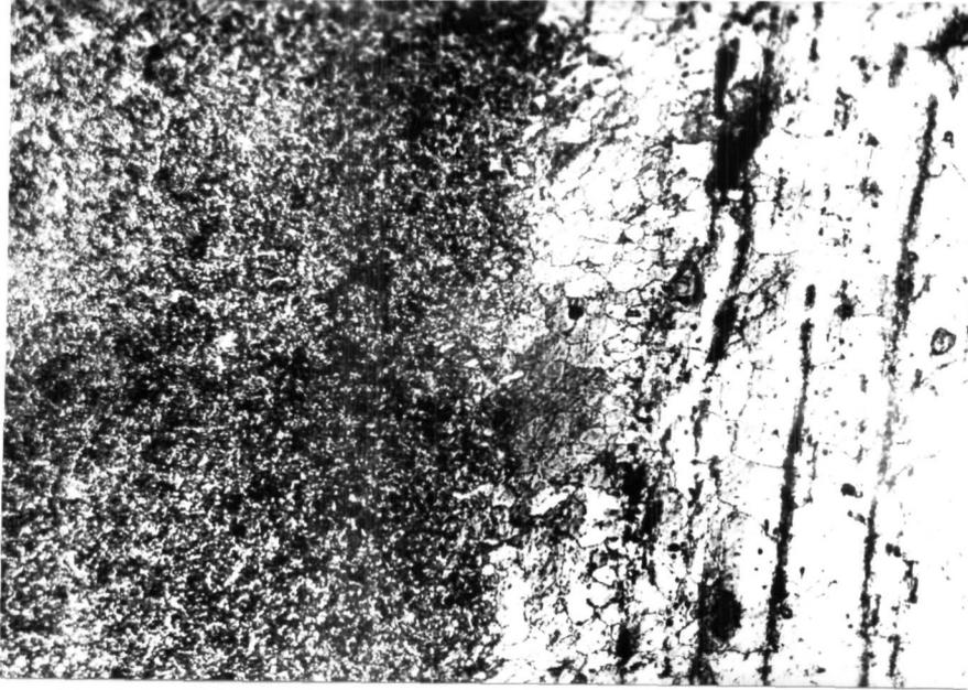
Рис.3.10. Переходная зона кузнечной сварки
